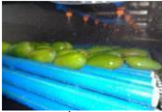
Hình 28: Hệ thống xử lý nước nóng
